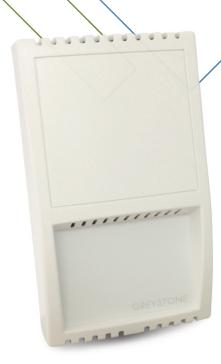
Asérie RH1 10A utiliza um sensor de umidade de capacitância com base em polímero termofixo altamente preciso e confiável e um sensor de temperatura RTD de platina, juntamente com modernos circuitos compensados de linearização e temperatura em uma caixa discreta e atrativa, para monitorar os níveis de umidade e temperatura ambiente. Está disponível com display de LCD em linha dual opcional.
