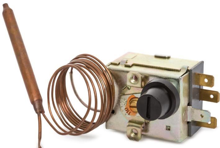
Termostato capilar com sonda por dilatação de líquido, com polo simples, limitador de temperatura de segurança com rearme manual ou automático e segurança positiva, em caso de ruptura do capilar. Indicado para uso em caldeiras, instalações de aquecimento e qualquer aplicação que necessite do estabelecimento de uma faixa limite de temperatura para o ideal funcionamento da instalação.
